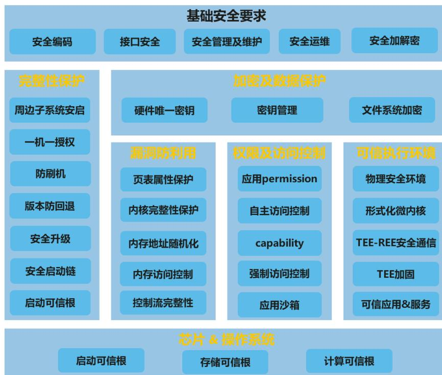
上图为典型的 HarmonyOS 单设备系统安全架构，在不同种类 HarmonyOS 设备上的实现会存在差异，取决于设备的威胁分析（风险高低）和设备的软硬件资源。HarmonyOS 在参考业界权威的安全分级模型基础上，结合 HarmonyOS 实际的业务场景和设备分类，将 HarmonyOS 设备的安全能力划分为 5 个安全等级：SL1-SL5。HarmonyOS 操作系统生态体系中，要求高一级的设备安全能力，默认是包含低一级的设备安全能力。
